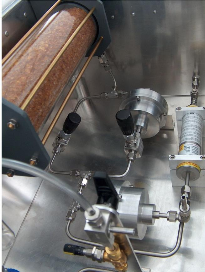
**Abbildung 5: Detailansicht des Diffusionstrockners und der Verdünnungsstufe**
