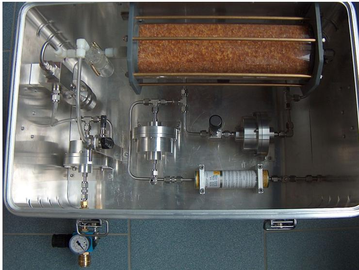
**Abbildung 3: Draufsicht auf die Aerosolzerzeugungseinheit**
