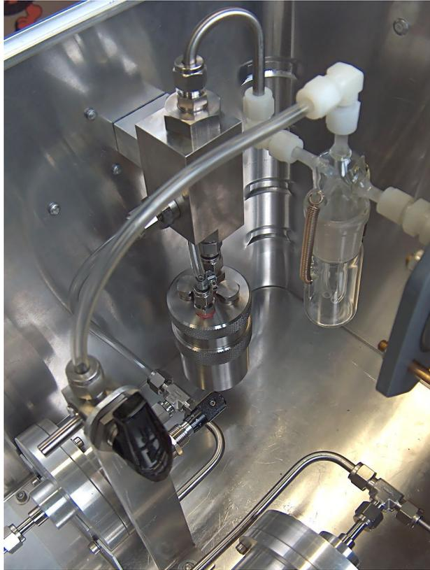
**Abbildung 4: Detailansicht des Partikelgenerators (Zerstäubers)**
