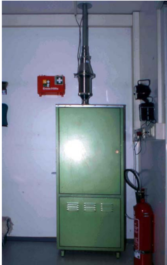
Abbildung 6 Probenahmesystem nach DIN ISO 12884
