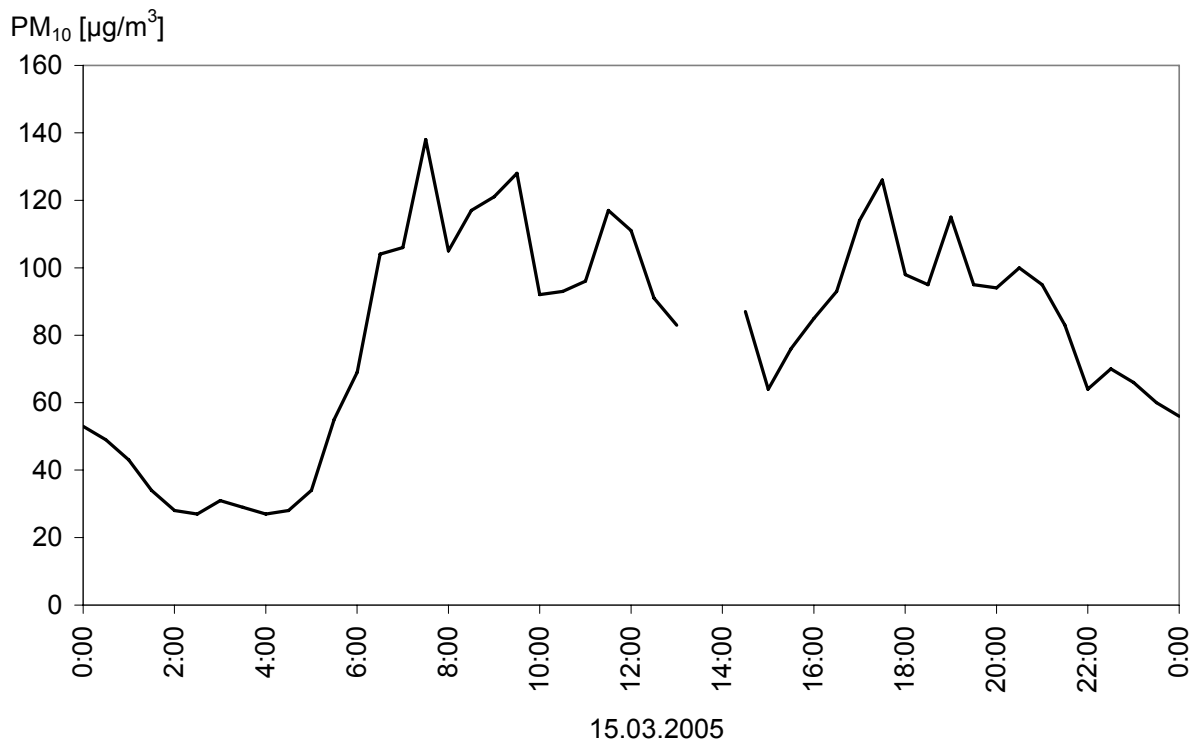
Abb. 4-24: PM_{10} -Tagesgang am Schlesischen Platz bei überwiegend lokal verursachten Überschreitungen
