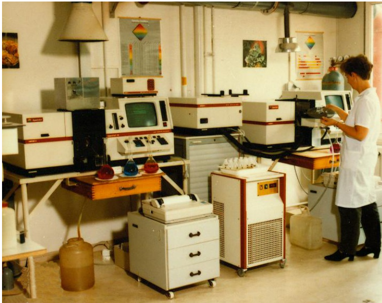
Bestimmung von Spurenelementen mit links: Graphitrohr-AAS, rechts: ICP-Massenspektrometer
