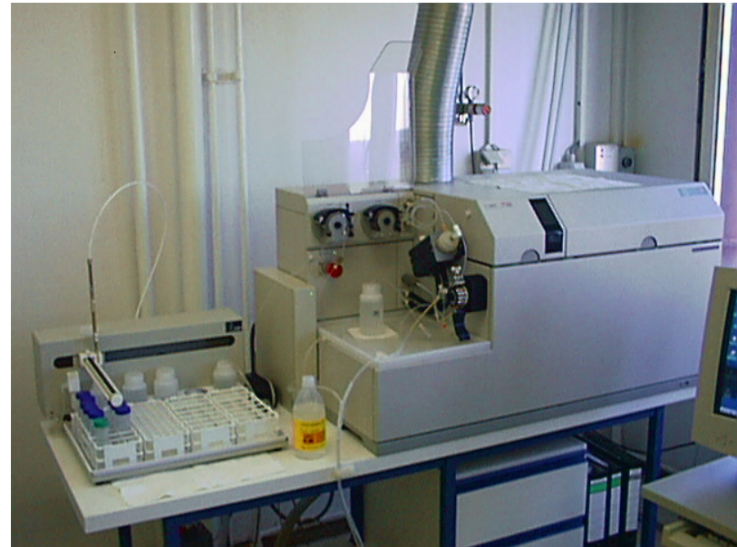
Bestimmung von Spurenelementen mit links: Graphitrohr-AAS, rechts: ICP-Massenspektrometer
