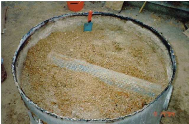
Abb. 4.1: Filterrohr für den Sickerwasserablauf am Lysimeterboden
