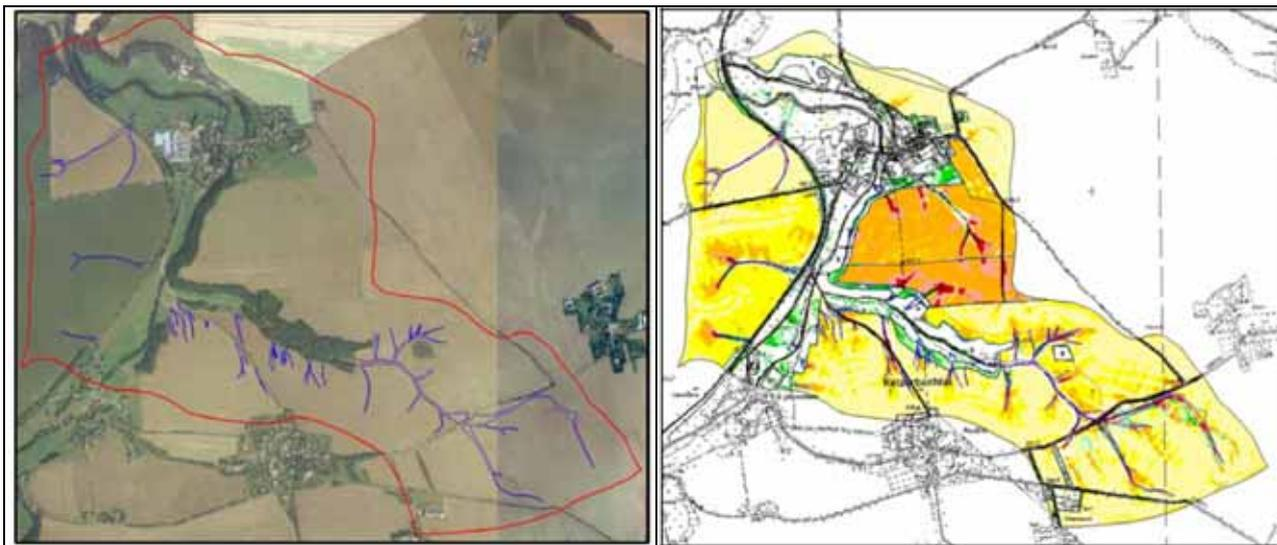
**Abb. 4–3: Lineare Erosionserscheinungen im Luftbild im Einzugsgebiet der Schiere (Blau nachgezeichnet; LfUG, September 2002) im Vergleich zur Erosionsprognose mit Hilfe von E3D für das Erosionsereignis im August 2002 (TU BERGAKADEMIE FREIBERG 2006, S. 67)**
