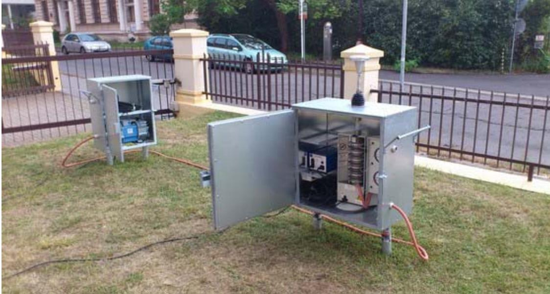
Abbildung 25: MOUDI™ Kaskadenimpaktor (rechts) nebst Vakuumpumpe (links) in Ústí nad Labem.
