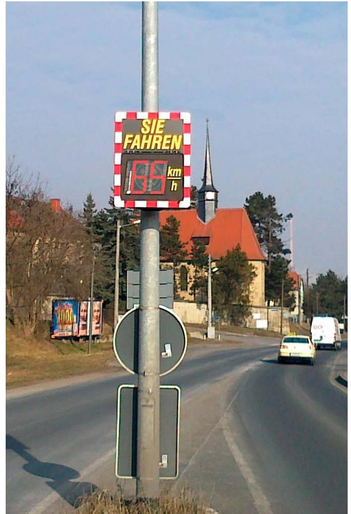
Abbildungen 15/16: Einsatz von Geschwindigkeitsmesstafeln/Dialogdisplays
