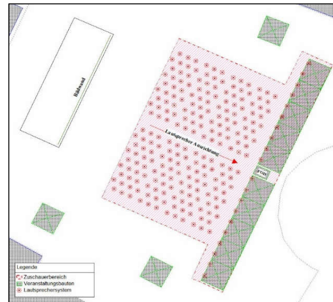
Lagepläne der untersuchten Beschallungskonzepte (links: zentral; rechts: dezentral)
