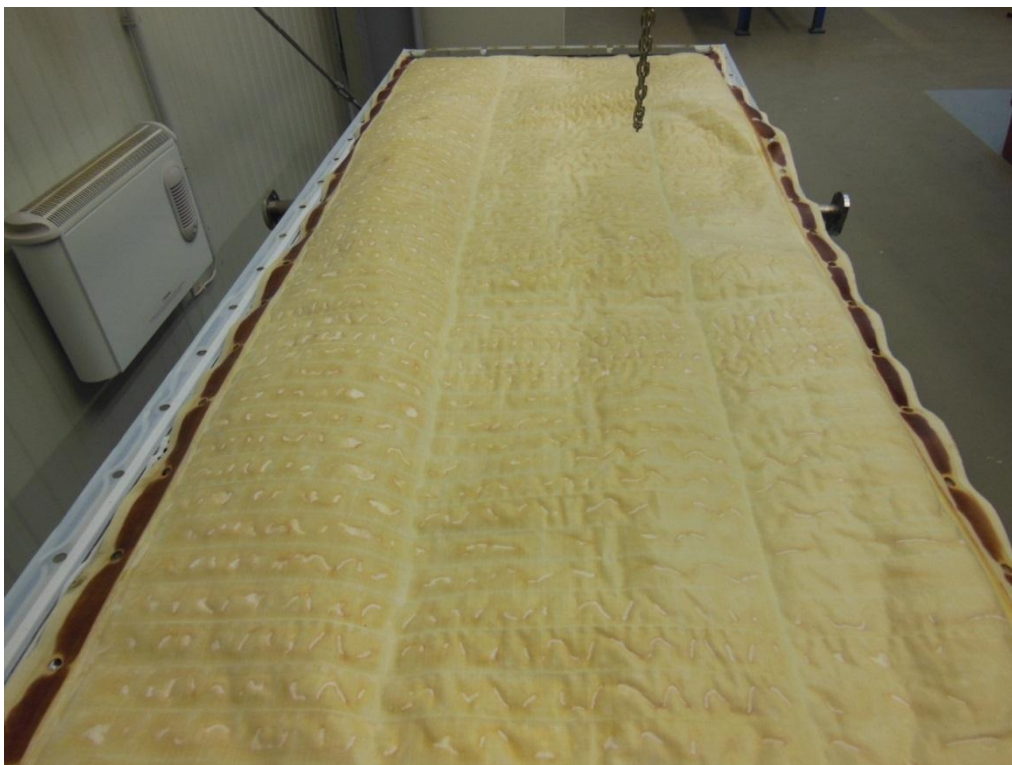
Abbildung 28: Demontage der Zellen / Anionenaustauschermembran nach Dauerbetrieb
