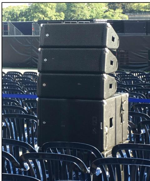
Abbildung 2: Beispiel für gestacktes Array mit 3 Elementen (auf Subwoofer)
