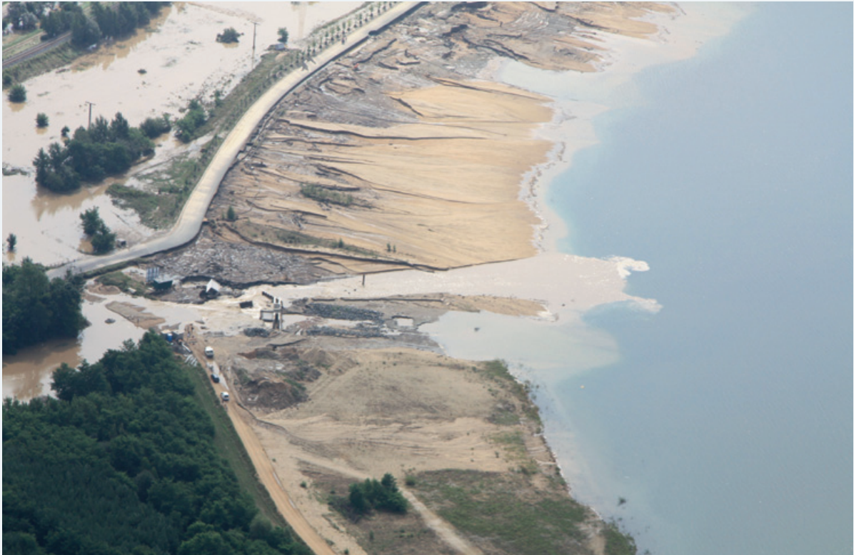
Abbildung 9-26: Ausschnitte des Bereiches des Wasserübertrittes von der Lausitzer Neiße in den Berzdorfer See (Foto: SMI)
